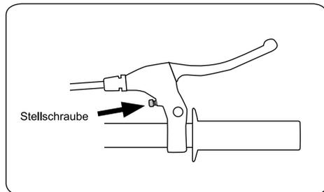
Stellen Sie die Zugspannung so ein, dass der Bremshebel auch bei starker Betätigung nicht den Lenkergriff berührt!
