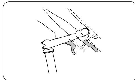
Um die Bremshebel auch bei kleineren Händen sicher greifen zu können, wird der Bremshebel mit einer Stellschraube (im Hebel) weiter an den Lenker herangestellt.
