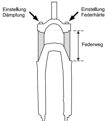
Die Abstimmung einer Federgabel muss nach Bedienungsanleitung des Gabelherstellers erfolgen. Generell gilt, dass die Gabel beim Überfahren von Unebenheiten merklich arbeiten, aber nicht „durchschlagen“, also bis auf Anschlag einfedern sollte.
